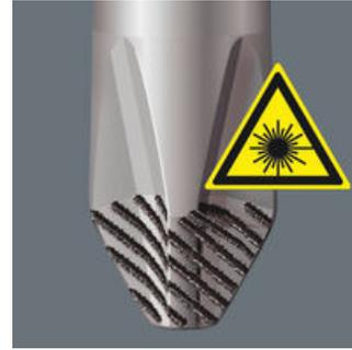
ヴェラレーザーチップはレーザー加工を通して1000 HV 0.3の硬いほどギザ歯を刃先に施します。その構造から生じた食いつきの効果はカムアウトを防ぎます。マイナス、プラス、ポジドライブ、トルクスネジに対応可。
