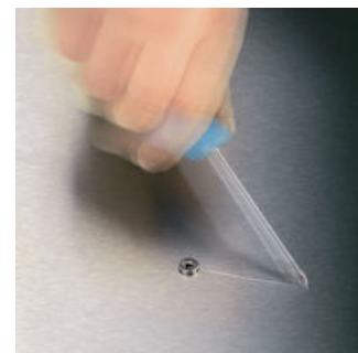
ネジ締め作業時に、ネジ頭からドライバーの先端が滑り落ちてしまうことが度々あります。工具、材質ともに傷つけてしまう可能性があります。ヴェラのレーザー加工が施された先端はギザが刻まれたようになっていきます。これがネジ頭に"食いつき"滑り落ちる事(カムアウト)を防ぎます。カムアウト現象は今や過去のものとなりました。
