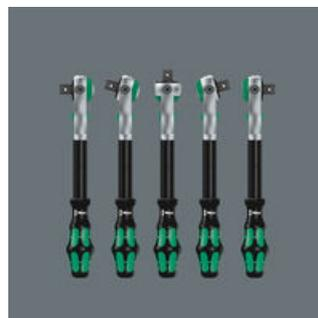
ラチェットヘッドは首を18°自由に回転でき、ホイールスイッチで回転方向の変更が可能。限られた狭いスペースで作業するときは、首の左右に0°、15°、90°の動作角度で固定できるので、滑ることなく安全に作業できます。
