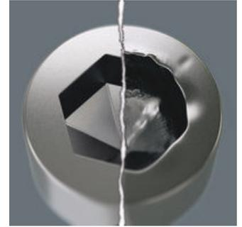
六角ネジには一つの問題があります。工具とネジの接触面積が小さいため、ネジ頭が摩耗、破損し、凹部が丸みを帯びていきます。これにより通常の六角ネジ用の工具を使ってもなめるようになります。ヘックスプラスは、広く接触するように設計しています。これにより、角だけではなく、角と角を接続する線にも接触して作業できるため、一般の六角レンチに比べて伝達できるトルクが20%増えます。また、なめるリスクも軽減しています。ヘックスプラスは、六角ネジに対応しています。
