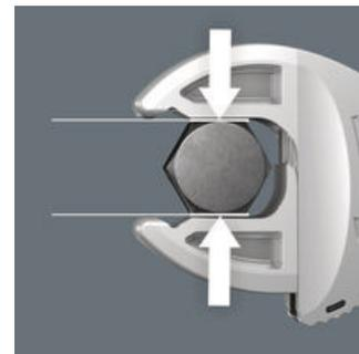
Joker 6004の平行で滑らかな開口部は、その表面圧力により、トルクを伝達する時に摩擦によるナットとボルトのエッジの変形を防ぐことができます。
