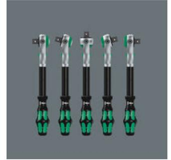
ラチェットヘッドは首を180°自由に回転でき、ホイールスイッチで回転方向の変更が可能。限られた狭いスペースで作業するときは、首の左右に0°、15°、90°の動作角度で固定できるので、滑ることなく安全に作業できます。
