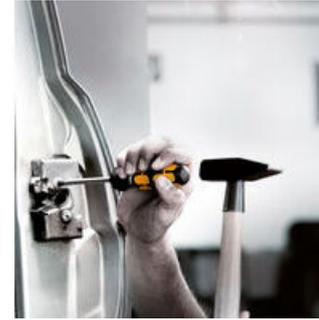
通常のドライバーをタガネとして使用するのは非常に危険です。ヴェラの貫通ドライバーはネジ締め作業だけでなく、ハンドルの後部をハンマーで叩きタガネとして使用することが可能です。ヴェラの貫通ドライバーは過酷な作業にも耐えられるタフなドライバーです。
