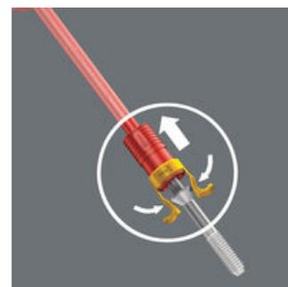
表面に接触するクリップ両端の腕は、表面を押し付けられると、両方が広がる為、狭く深い穴にあるネジにも届きます。締付終了したら、弾力性のある素材のため自動的に元に戻ります。
