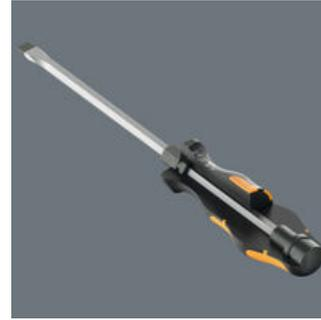
チゼルドライバーは、ネジ回しのみならず、その他の作業を必要とする際に役に立ちます。固着したネジやホースクランプの締め付け、緩め、タガネ、ほぞ穴加工に。インパクトキャップ一体型で、製品寿命を延ばし、飛散のリスクを軽減します。ハンマーの打撃でもロスのない力の伝達を実現した、高品質素材で作られたパウンドスルー六角ブレード付き。ブレードの割れや破損を防ぐ頑丈な強化素材。一体型六角ボルトスターにレンチやリングスパナを取り付けることで、より多くのトルクを伝達することが出来ます。
