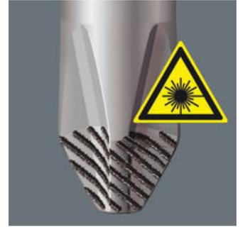
ヴェラレーザーチップはレーザー加工を通して1000 HV 0.3の硬いほどギザ歯を刃先に施します。その構造から生じた食いつきの効果はカムアウトを防ぎます。マイナス、プラス、ポジドライブ、トルクスネジに対応可。
