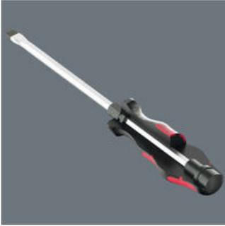
チゼルドライバーは、ネジ回しのみならず、その他の作業を必要とする際に役に立ちます。固着したネジやホースクランプの締め付け、緩め、タガネ、ほぞ穴加工に。インパクトキャップ一体型で、製品寿命を延ばし、飛散のリスクを軽減します。ハンマーの打撃でもロスのない力の伝達を実現した、高品質素材で作られたパウンドスルー六角ブレード付き。ブレードの割れや破損を防ぐ頑丈な強化素材。一体型六角ボルスターにレンチやリングスパナを取り付けることで、より多くのトルクを伝達することが出来ます。
