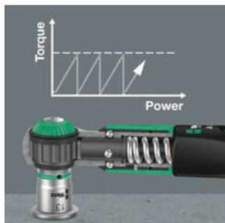
Safe-Torque A1トルクレンチには、空回り機能が組み込まれています。設定トルクに達すると、締め付け作業が止まるため、過大なトルクがかかることはありません。
