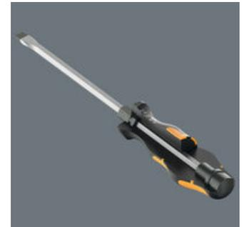
チゼルドライバーは、ネジ回しのみならず、その他の作業を必要とする際に役に立ちます。固着したネジやホースクランプの締め付け、緩め、タガネ、ほぞ穴加工に。インパクトキャップ一体型で、製品寿命を延ばし、飛散のリスクを軽減します。ハンマーの打撃でもロスのない力の伝達を実現した、高品質素材で作られたパウンドスルー六角ブレード付き。ブレードの割れや破損を防ぐ頑丈な強化素材。一体型六角ボルスターにレンチやリングスパナを取り付けることで、より多くのトルクを伝達することが出来ます。
