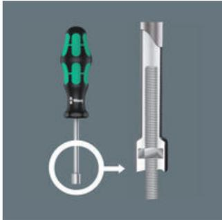
ボルト軸のナットを取り外すには、中空シャフトドライバーが必要です。ナットを介してネジを締めることが可能です。
