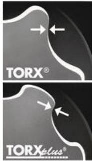
通常のトルクス形状と比べると、トルクスプラスの形状は丸みを帯びており、ツールからネジにトルクを伝達する側面が6箇所とも拡大しています。これは、作業時にネジに加えられる力がより大きな接触面積に広がり、高いトルクが伝達できるので、ネジと工具両方の耐久年数を延ばします。切削加工の"センターロック"は、トルクスプラス形状の典型的な用途を表しています。超硬切削工具(カーバイド)が先端にもたらず高熱は、固定用のネジを"焼き付け"、ネジを緩めるときにトルクを大幅に増加させる形状が必要です。このため、トルクが安定化されたトルクスプラス形状により、ネジの損傷を防ぎ、コストのかかる設備のダウンタイムを減らしています。
