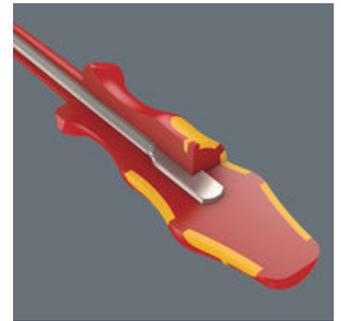
ヴェラ クラフトフォームハンドルは、異なる特性を持つ複数の素材で作られています。ハンドルのコア部分は摩耗耐性のプラスチックで作られており、大きな力が加えられても、ブレードをしっかりと掴むことができます。カラフルな柔らかいゾーンは、トルク伝達を向上させるために摩擦抵抗が大きい柔らかい素材で作られています。表面の赤いゾーンは、手がハンドルに「吸着」するのを防ぎ、ハンドルを握り直すのを容易にしています。
