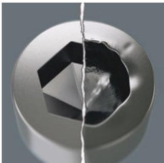
六角ネジには一つの問題があります。工具とネジの接触面積が小さいため、ネジ頭が摩耗、破損し、凹部が丸みを帯びていきます。これにより通常の六角ネジ用の工具を使ってもなめるようになりやすくなります。ヘックスプラスは、広く接触するように設計しています。これにより、角だけではなく、角と角を接続する線にも接触して作業できるため、一般の六角レンチに比べて伝達できるトルクが20%増えます。また、なめるリスクも軽減しています。ヘックスプラスは、六角ネジに対応しています。
