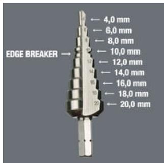
9段ドリル、段と段の間、幅差が2mmで、材料（板金）の厚みは最大4.5mmまで対応、切り刃がØ10ギアは板金1mmに対応しております。
