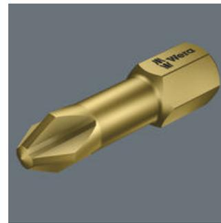
THトーションビットはトーションゾーン付きのハードビットです。トーションゾーンにより、衝撃を吸収し、早期摩耗を防ぎ、ビットの寿命が延ばされます。
