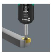
このツールセットは特に超硬チップのボルト締め作業に適しています。Safe Torque スピード 7510トルクレンチは主要超硬ツールメーカーが推奨する5つのトルク値を選択でき、交換可能な超硬チップの確実なトルク制御によるネジ止めを保証します。
