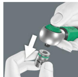
ボールロックにより、ソケットとアクセサリを確実に固持できるため、ねじ回し時の安全性も確保される。ラチェットヘッドのリリースボタンを短く押すと、ボールロックが解除される。
