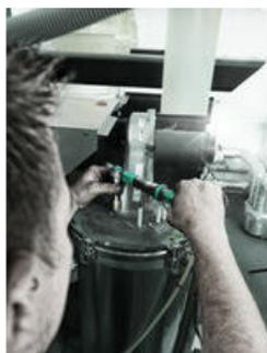
Safe-Torque A 1トルクレンチは、6.35mmの四角取付があり、6.35mmソケットに適している。
