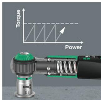
Safe-Torque A1トルクレンチには、空回り機能が組み込まれている。設定トルクに達すると、締め付け作業が止まるため、過大なトルクがかかることはない。
