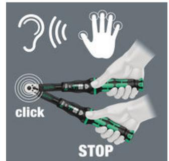
設定のトルク値に達すると、音と振動を伝える機構が作動します。
