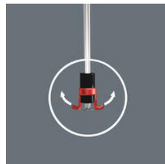
表面に接触するグリッパ両端の腕は、表面を押し付けられると、両方が広がる為、狭く深い穴にあるネジにも届きます。弾力性のある素材のため自動的に元に戻ります。
