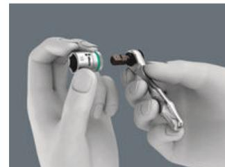
ビットとソケット。ビットは直接サイクロップミニラチェット1に取り付けて使えますが、ホルダーと接続してから、ビットを差し込むこともできます。これにより、ホルダーをエクステンションバーとして使え、ホルダーに付いてるスリーブで早回しを実現します。ソケットを接続するには、ヴェラ 870/1アダプター（サイクロップミニ 1セットにも含まれている）のような1/4" 六角差し込みから1/4" 四角差し込みに変換するアダプターが必要です。
