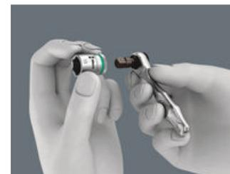
ビットとソケット。ビットは直接サイクロップミニラチェット1に取り付けて使えますが、ホルダーと接続してから、ビットを差し込むこともできます。これにより、ホルダーをエクステンションバーとして使い、ホルダーに付いてるスリーブで早回しを実現します。ソケットを接続するには、ヴェラ 870/1アダプター（サイクロップミニ 1セットにも含まれている）のような1/4" 六角差し込みから1/4" 四角差し込みに変換するアダプターが必要です。
