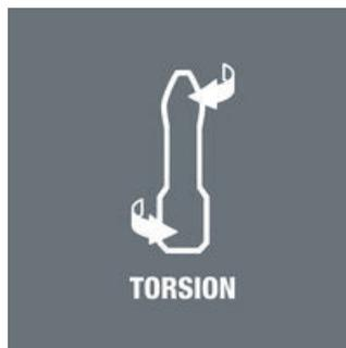
トーションビットはトーシオンゾーン付きのハードビットです (T)。トーシオンゾーンにより、衝撃を吸収し、早期摩耗を防ぎ、ビットの寿命が延ばせます。
