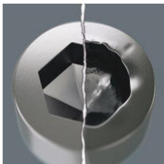
六角ネジには一つの問題があります。工具とネジの接触面積が小さいため、ネジ頭が摩耗、破損し、凹部が丸みを帯びていきます。これにより通常の六角ネジ用の工具を使ってもなめるようになりません。ヘックスプラスは、広く接触するように設計しています。これにより、角だけではなく、角と角を接続する線にも接触して作業できるため、一般の六角レンチに比べて伝達できるトルクが20%増えます。また、なめるリスクも軽減しています。ヘックスプラスは、六角ネジに対応しています。
