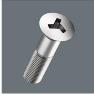
トライウィングは、主に航空や家庭用電子部品に使用されています。その先端にある3枚羽の非対称形状により、他のツールより効率が良くなっています。高精度製造により、先端がネジ頭にしっかりとフィットし、高品質の鋼で作られたブレードは、硬化処理されて、工具の耐久年数が延ばされます。
