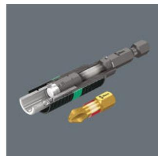
ビットとホルダーのトーションゾーンが、力が掛かったときにねじれ、衝撃を吸収することにより工具にかかる負荷を軽減させます。2段階構えにより負荷を大幅にカットし、早期破損を防ぎます。さらに、それぞれの用途に合ったビットを選ぶことにより、長い耐久年数に繋がります。
