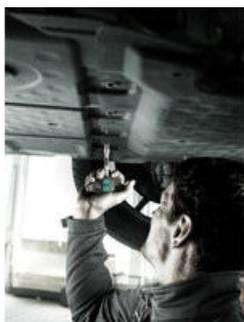
411 A RA T型ハンドルは、6.35mmソケットレンチ差込に適している。ソケットレンチは、ボールを介してしっかりとロックされている。
