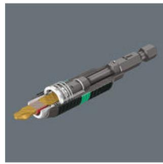
ヴェラ独自のバイトーションデザインは、力を加えたときの衝撃を吸収するトーションゾーンをシャフト部のゾーンとビット軸のゾーンの2段階構えることによって、工具にかかる負荷を大幅にカットします。
