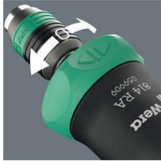
直感的に切り替えられるラチェット機構。スイッチを時計回りに回すと時計回りのネジ回し、反時計回りに回すと反時計回りのネジ回しになります。ポジション0でラチェット機構をロックすることで正確な作業を行うことができます。
