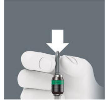
スリーブを動かさずに、ビットをアダプターに装着してしっかりビットを固定することができます。
