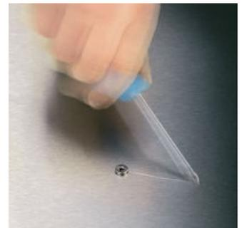
ネジ締め作業時に、ネジ頭からドライバーの先端が滑り落ちてしまうことが度々あります。工具、材質ともに傷つけてしまう可能性があります。怪我を負う恐れもあります。ヴェラのレーザー加工が施された先端はギザが刻まれたようになっていきます。これがネジ頭に"食いつき"滑り落ちる事(カムアウト)を防ぎます。カムアウト現象は今や過去のものとなりました。
