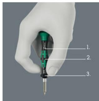
パワーゾーン(1)、早回しゾーン(2)、精密ゾーン(3)を備えたKraftform Micro ビットホルダーは、精密機器結合の要件を完全に満たしています。手を休めることができるスムーズランニングキャップは、こうした利点をしっかりとサポートしてくれます。4ミリ六角ビットに適しています。
