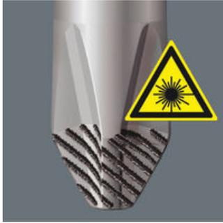
ヴェラレーザーチップはレーザー加工を通して1000 HV 0.3の硬いほどギサ歯を刃先に施します。その構造から生じた食いつきの効果はカムアウトを防ぎます。マイナス、プラス、ポジドライブ、トルクスネジに対応可。
