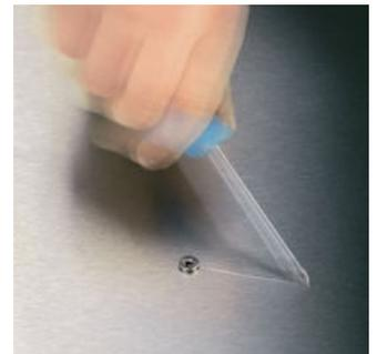
ネジ締め作業時に、ネジ頭からドライバーの先端が滑り落ちてしまうことが度々あります。工具、材質ともに傷つけてしまう可能性があります。怪我を負う恐れもあります。ヴェラのレーザー加工が施された先端はギザが刻まれたようになっています。これがネジ頭に"食いつき"滑り落ちる事(カムアウト)を防ぎます。カムアウト現象は今や過去のものとなりました。
