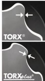
通常のトルクス形状と比べると、トルクスプラスの形状は丸みを帯びており、ツールからネジにトルクを伝達する側面が6箇所とも拡大しています。これは、作業時にネジに加えらる力がより大きな接触面積に広がり、高いトルクが伝達できるので、ネジと工具両方の耐久年数を延ばします。切削加工の"センターロック"は、トルクスプラス形状の典型的な用途を表しています。超硬切削工具(カーバイド)が先端にもたらす高熱は、固定用のネジを"焼き付け"、ネジを緩めるときにトルクを大幅に増加させる形状が必要です。このため、トルクが安定化されたトルクスプラス形状により、ネジの損傷を防ぎ、コストのかかる設備のダウンタイムを減らしています。
