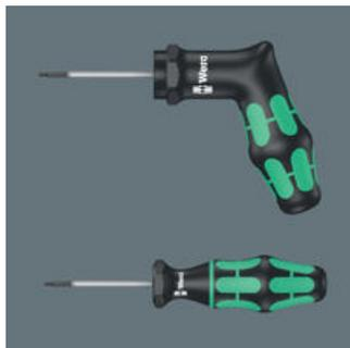
ヴェラ単能型トルクドライバーは、工場を出荷する前に推奨値に従ってトルク値が設定されています。これらの設定値は主に、トルクスネジ、トルクスプラスネジ、六角ネジに基づいて設定され、簡単かつ安全にネジを外すことができます。精度: +/- 10 %
