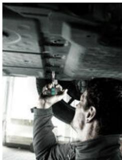
411 A RA T型ハンドルは、6.35mmソケットレンチ差込に適している。ソケットレンチは、ボールを介してしっかりとロックされている。
