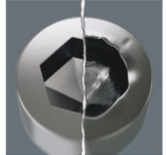
六角ネジには一つの問題があります。工具とネジの接触面積が小さいため、ネジ頭が摩耗、破損し、凹部が丸みを帯びていきます。これにより通常の六角ネジ用の工具を使ってもなめるようになりません。ヘックスプラスは、広く接触するように設計しています。これにより、角だけではなく、角と角を接続する線にも接触して作業できるため、一般の六角レンチに比べて伝達できるトルクが20%増えます。また、なめるリスクも軽減しています。ヘックスプラスは、六角ネジに対応しています。
