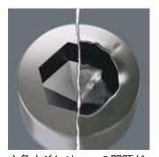
六角ネジには一つの問題が あります。工具とネジの接 触面積が小さいため、ネジ 頭が摩耗、破損し、凹部が 丸みを帯びていきます。こ れにより通常の六角ネジ用 の工具を使ってもなめるよ うになります。 ヘックスプ ラスは、広く接触するよう に設計しています。これに より、角だけではなく、角 と角を連接する線にも接触 して作業できるため、一般 の六角レンチに比べて伝達 できるトルクが20%増えま す。また、なめるリスクも 軽減しています。ヘックス プラスは、六角ネジに対応 しています。
