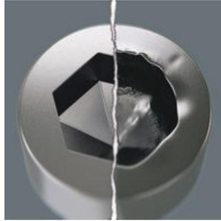
六角ネジには一つの問題があります。工具とネジの接触面積が小さいため、ネジ頭が摩耗、破損し、凹部が丸みを帯びていきます。これにより通常の六角ネジ用の工具を使ってもなめるようになります。ヘックスプラスは、広く接触するように設計しています。これにより、角だけではなく、角と角を接続する線にも接触して作業できるため、一般の六角レンチに比べて伝達できるトルクが20%増えます。また、なめるリスクも軽減しています。ヘックスプラスは、六角ネジに対応しています。
