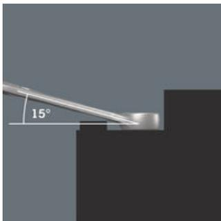
メガネレンチヘッドは、レンチの軸に沿って15°傾けられていて、作業中の損傷を避けます。
