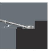
メガネレンチへッドは、レンチの軸に沿って15°傾けられていて、作業中の損傷を避けます。
