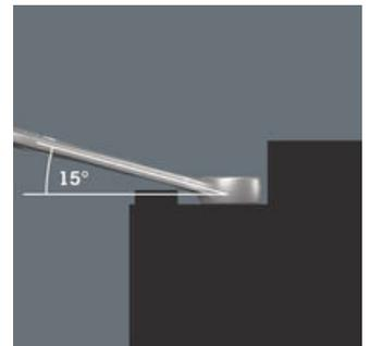
メガネレンチヘッドは、レンチの軸に沿って15°傾けられていて、作業中の損傷を避けます。
