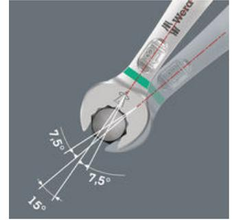
回転角度は7.5度のスパナ部とダブルヘックス開口部により、レンチの使用が適切な場合(準備-締め付け-回転-再準備-締め付け-回転)、スイング角度は30度以下のネジを回すことができます。
