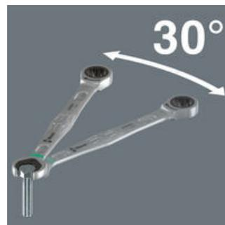
狭いスペースで、ボルトやナットを締めたり緩めたりするには、一般の回転角 60° で裏返ししながら作業する必要があります。ジョーカーの特別なダブルヘックスデザインにより、回転角が 30 度になり、裏返す必要がなくなります。ジョーカーは、一般のスパナレンチが利用できない狭いスペースで重宝されます。リミットストップは錆びたボルトに食いつくこともできます。
