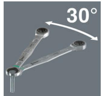
狭いスペースで、ボルトやナットを締めたり緩めたりするには、一般の回転角60°で裏返ししながら作業する必要があります。ジョーカーの特別なダブルヘックスデザインにより、回転角が30度になり、裏返す必要がなくなります。ジョーカーは、一般のスパナレンチが利用できない狭いスペースで重宝されます。リミットストップは錆びたボルトに食いつくこともできます。
