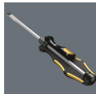
ヴェラ クラフトフォームハンドルは、異なる特性を持つ複数の素材で作られています。ハンドルのコア部分は摩耗耐性のプラスチックで作られており、大きな力が加えられても、ブレードをしっかりと掴むことができます。黄色の柔らかいゾーンは、トルク伝達を向上させるために摩擦抵抗が大きい柔らかい素材で作られています。表面の黒いゾーンは、手がハンドルに"吸着"するのを防ぎ、ハンドルを握り直すのを容易にしています。
