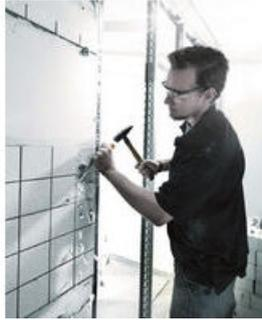
通常のドライバーをタガネとして使用するのは非常に危険です。ヴェラの貫通ドライバーはネジ締め作業だけでなく、ハンドルの後部をハンマーで叩きタガネとして使用することが可能です。ヴェラの貫通ドライバーは過酷な作業にも耐えられるタフなドライバーです。
