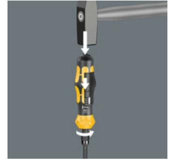
インパクトレンチ機能をオンにすると、ハンマーによる衝撃が最大25Nmの緩みトルクに変換される。貫通軸を介して力の伝達を保つ。
