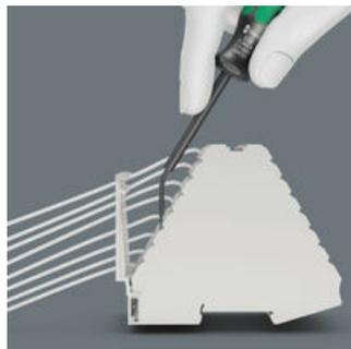
端子ブロックがワイヤー端を機械的に固定します。このために必要な力は、張力ばね端子のばねが適用します。ワイヤー端を挿入するには、ツールでばねを開く必要があります。Weraが提供する特殊な引き抜き工具は、スイッチキャビネットなどの狭い空間であっても、張力ばね端子を操作できます。反り状のブレードは、直線ブレードのツールが届かない場所でも、ばね端子を扱えます。
